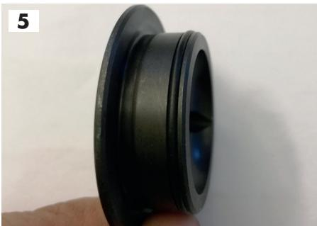
• Platzieren Sie den mitgelieferten O-Ring an die entsprechende Stelle auf der Druckplatte (Foto 5), damit dieser während der Montage des Kupplungsdeckels nicht herauspringt.
