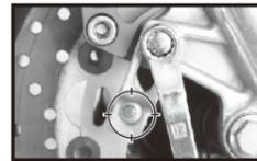
Stellen Sie die Position der Sensorhalterung so ein, dass der Sensor zum Magnet zeigt, um ein schlechtes Drehzahlsignal zu vermeiden.
