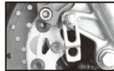
Installieren Sie die Sensorhalterung vom S-Typ.
