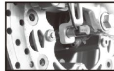
Installieren Sie den Drehzahlsensor an der Halterung.
